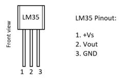
É importante destacar que este sensor pode ser alimentado com uma tensão de 4 a 20 V, e fornece em sua saída um sinal analógico de 10 mV/°C.
