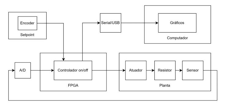
A entrada de temperatura deverá ler um valor digital de 8 bits de um conversor A/D, e a entrada de setpoint deverá ser lida de um botão tipo encoder.
