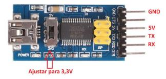
Os sinais enviados pela FPGA devem ser conectados ao pino RX do modulo, seguindo a temporização apropriada, conforme a figura a seguir.
