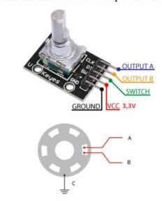
Quando pressionado o eixo do encoder uma chave conecta a saída SW ao GND.
